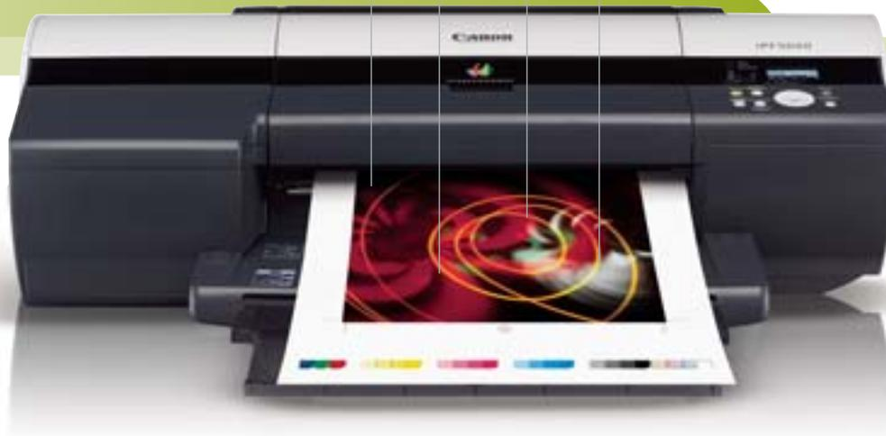
Das neue Tintensystem des iPF5000 mit 12 pigmentierten Tinten ist wirklich beachtlich: praktisch, beständig und ausgestattet mit der breitesten Farbskala seiner Klasse bei einer Medienbreite von 17".
