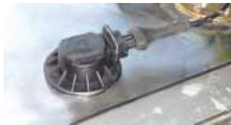
Kernstück des ECOsens®-Systems : der Kraftstoffsensoren .
