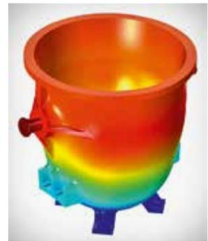
*Simulation der Deformation*
