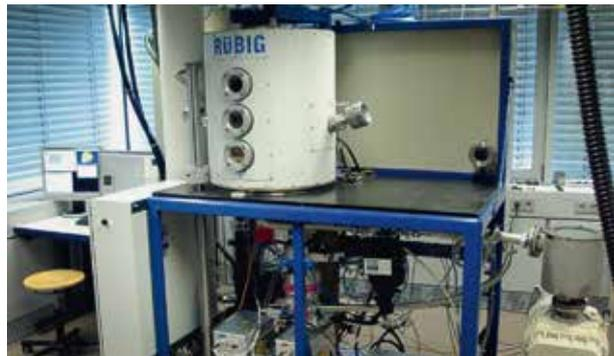
PVD-Beschichtungsanlage (physical vapour deposition)
