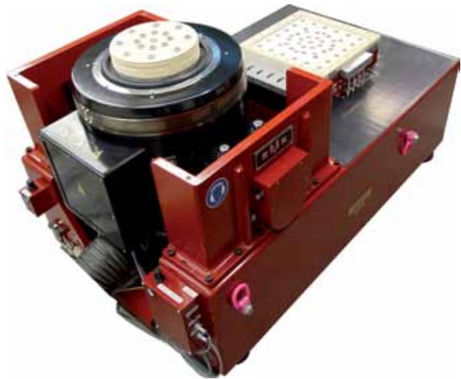
Schwingprüfanlage mit Gleittisch TIZ Grieskirchen
