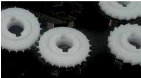
„Ausgedruckte“ Zahnräder – direkt aus dem 3D-Datensatz generiert.
