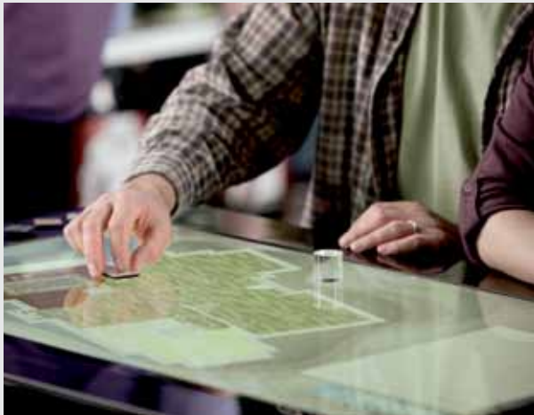
40" Display mit LED Backlight, Multi-Touch und Objekterkennung durch Microsoft® PixelSense™ Technologie
